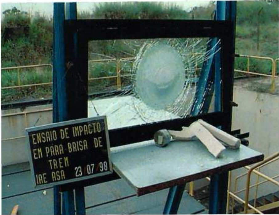
FOTO 4 - VISTA DO CORPO-DE-PROVA APÓS O 2º DISPARO
